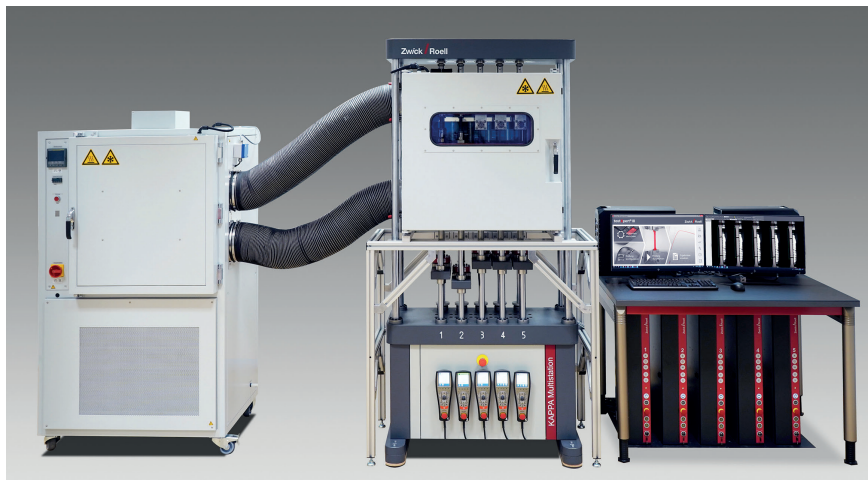
Bild 2. Die Multistation 5x10 kN mit kontrollierter Feuchteumgebung erlaubt Zeitstandprüfungen in kontrollierter Temperatur von +20°C bis +90°C und relativer Feuchte von 20 bis 90 Prozent. © ZwickRoell
